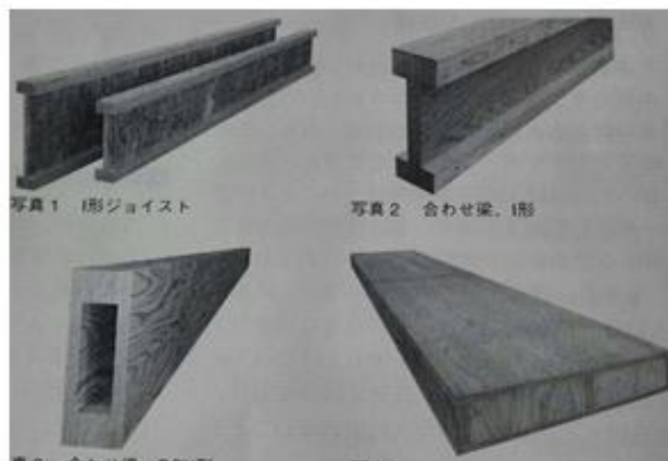
上图左为 I 型托梁、右为 I 型组合梁 下图左为箱型组合梁、右为覆面板
